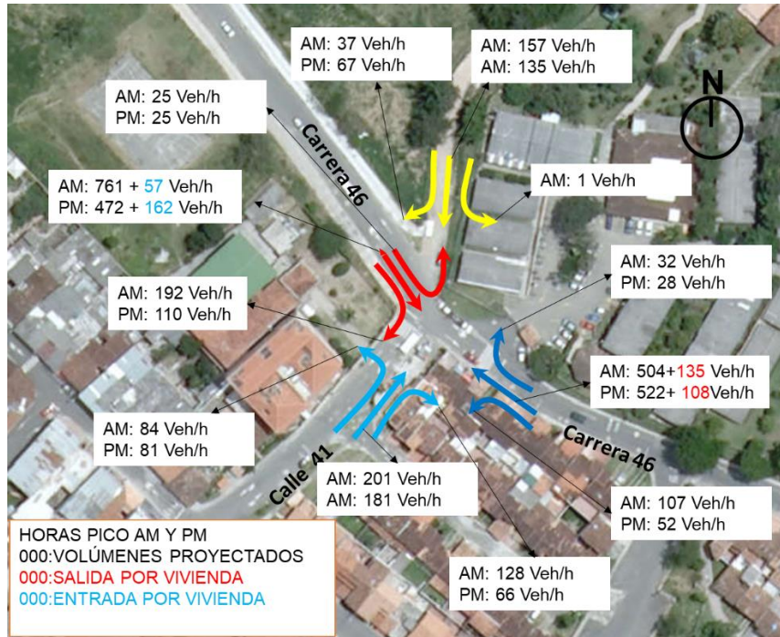
Figura 14.3-6 Esquema de volúmenes de la intersección del calle 41 con carrera 46 con proyección 5 años
