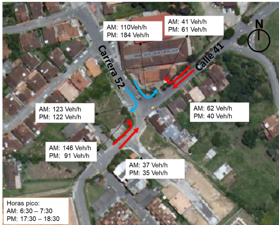
Figura 4.8-4 Volúmenes aforado en la hora pico del día laboral en la intersección de la carrera 52 con calle 41
