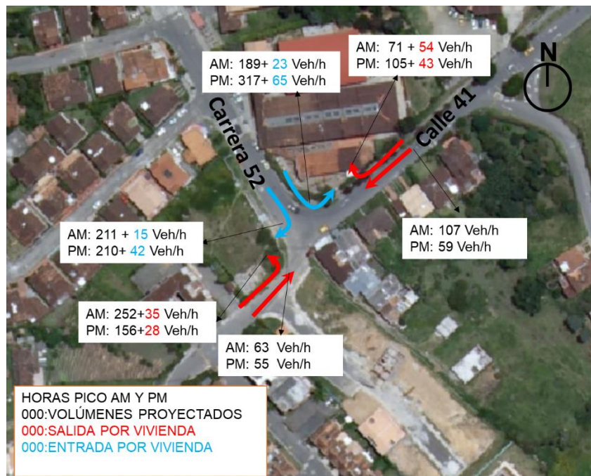
Figura 14.3-5 Esquema de volúmenes de la intersección del calle 41 con carrera 52 con proyección 5 años
