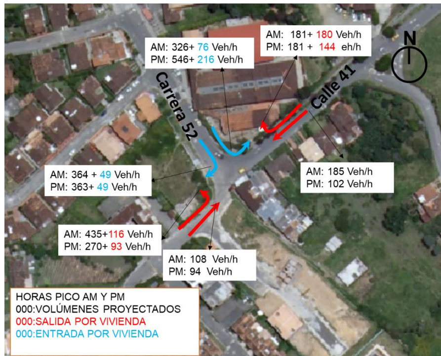
Figura 14.3-11 Esquema de volúmenes de la intersección del calle 41 con carrera 52 con proyección 10 años
